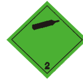
Gases no tóxicos y no inflamables
